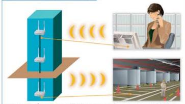
アクセスポイントの展開によりIPネットワーク拡張を 行うことによって、最上階から地下まで通信会話範囲を カバー出来ます。またIP無線機は歩きながらでも常に 最も近いアクセスポイントを選びます。
